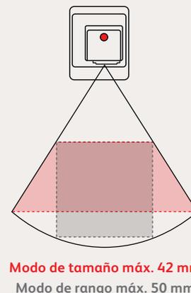
Alterne sin esfuerzo entre un rango de distancia focal mayor o un tamaño de campo de marcaje ampliado para poder realizar distintos trabajos.
