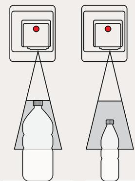
Ajuste automáticamente la distancia focal después de la configuración inicial del trabajo sin mover el sistema láser hacia arriba o hacia abajo, lo que reduce los errores y la intervención del usuario.
